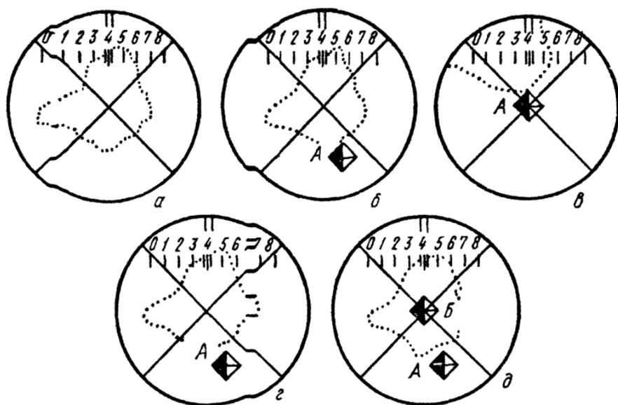
Рис. 2. Схема центровки прибора ПМТ-3
