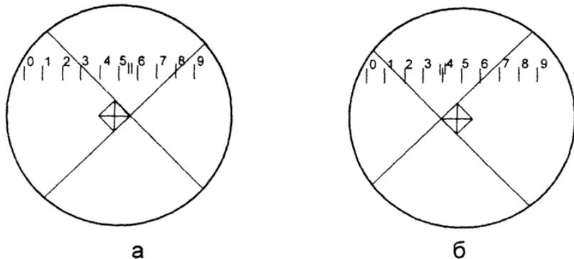
Рис. 3 Измерение диагонали отпечатка микротвердости
