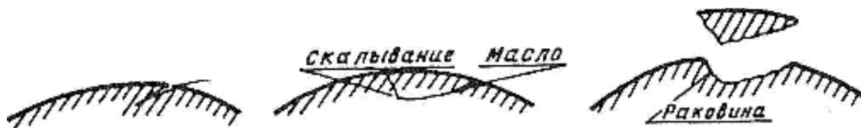
Рис. 1. Схема образования усталостной раковины
